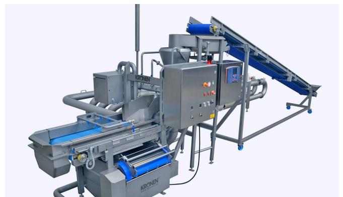
Waschergebnis, da die vorgeschaltete GEWA für das Entfernen von Schmutz und Insekten und der daran anschließende Vortex für die Behandlung mit einem Waschzusatz sorgt. Der Vortex lässt sich auch optimal in eine kontinuierliche Linienaufstellung integrieren.
