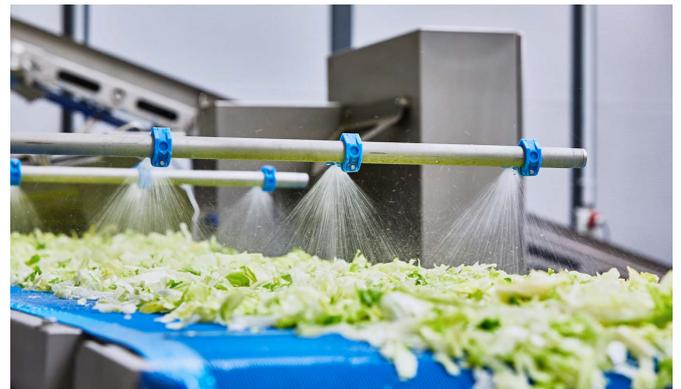
Wassers im Waschtank kann an verschiedene Produkte angepasst werden. Am Ende des Waschtanks wird das Produkt mit dem Wasser mittels Überlauf auf einen Vibrations- oder Bandaustrag transportiert und mit einer Frischwasserdusche abgesprüht. Das Wasser fließt durch ein Sieb in den Pumpentank, von wo es wieder zurück in den Waschtank gepumpt und erneut verwendet wird.
