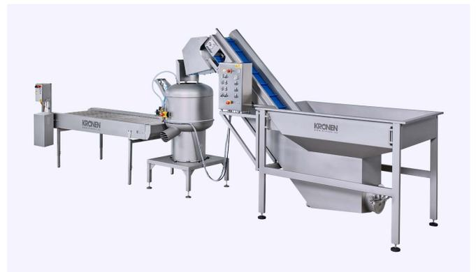
El proceso de llenado y pelado puede controlarse de forma centralizada a través de un control automático (opcional). De este modo, la máquina PL 40K puede integrarse perfectamente en líneas de producción completas para lavar, pelar y cortar en cubos las hortalizas de raíz.
