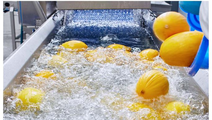
La capacidad depende de varios factores, por ejemplo, se pueden procesar aproximadamente 1000 kg de manzanas por hora con un tiempo de ciclo de 4,5 minutos (1,5 minutos para el llenado, 30 segundos de permanencia y 2,5 minutos para la salida).
