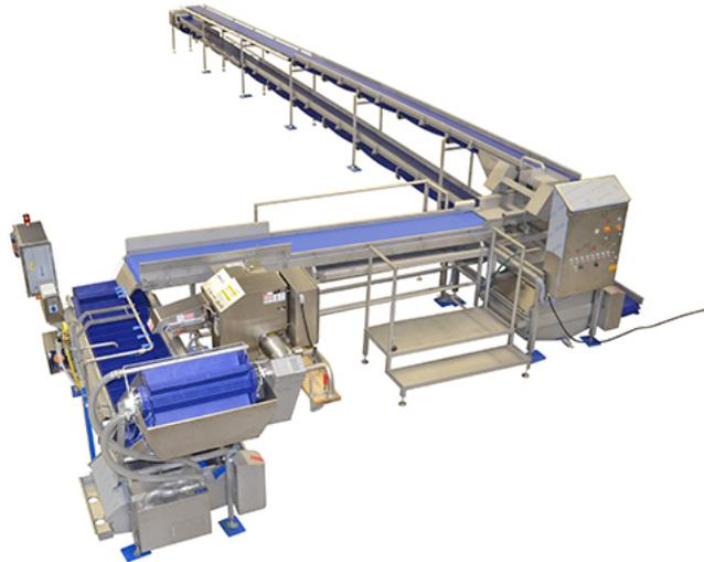
Die Linie zur Apfelverarbeitung kombiniert bestehende Maschinen verschiedener Hersteller mit neuen Maschinen und Transportbändern
