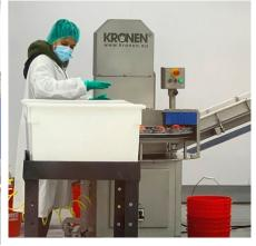
Ein Mitarbeiter wird benötigt, um die TONA S180K zu bedienen und die Produkthalter mit Äpfeln zu bestücken.
