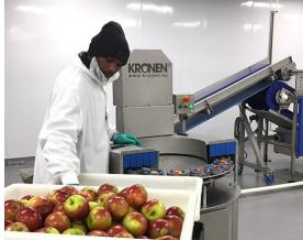
Die Apfelverarbeitungslinie bei Foodlink umfasst eine TONA S180K mit Austrageband, das sie mit dem Tauchbad KDB 120 verbindet
