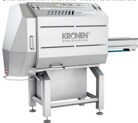
Die Bandschneidemaschine GS 10-2 kann durch Einstellung und Messerwechsel für verschiedene Schnitte eingesetzt werden.
