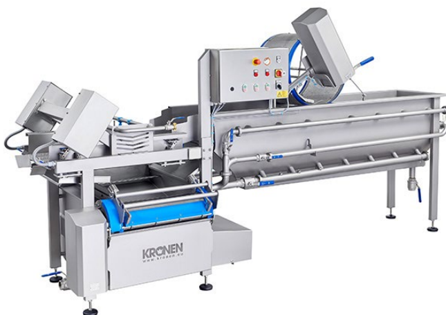
Mit einer Waschmaschine wie der GEWA 3800V PLUS werden verschiedene Gemüsesorten vor der weiteren Verarbeitung gewaschen.
