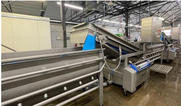
Die Waschl原因e besteht aus einem Putztisch und drei GEWA 4000 B PLUS HELICAL-Waschmaschinen und wurde in die bestehende Produktionshalle eingepasst.
