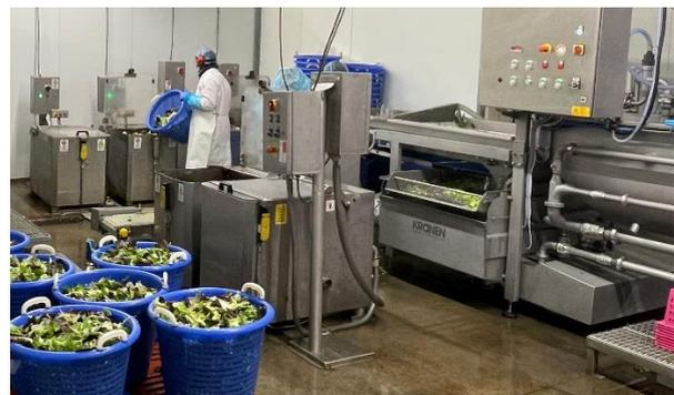
In der Waschl原因e wird der oft stark verschmutzte Salat zuverlässig und schonend von Erde befreit und zu verzehrfertigen Produkten verarbeitet.
