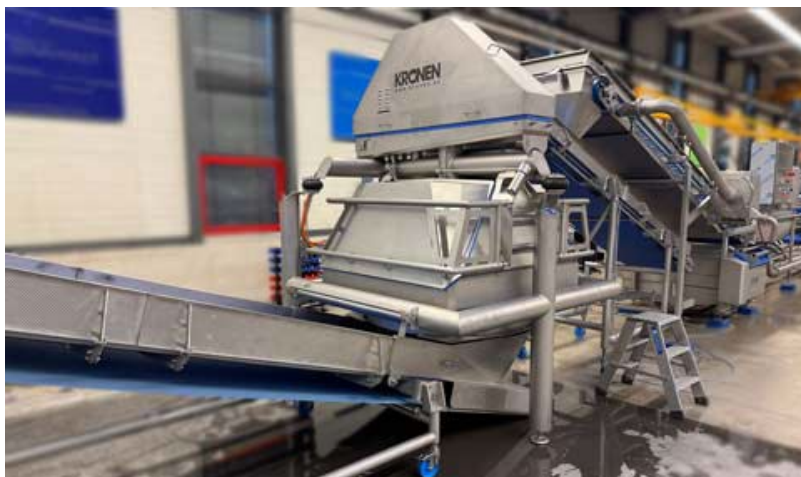
Die Linie zur Verarbeitung von Eisbergsalat umfasst ein kundenspezifisch angepasstes Trocknungssystem K850 von KRONEN.
