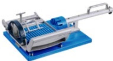
Eine Lösung aus dem Bereich der Handgeräte ist der MMC 150. Mit dem manuellen Melonen-Stückeschneider lassen sich vorbereitete Melonen schnell und einfach in Scheiben und zugleich Segmente teilen.
