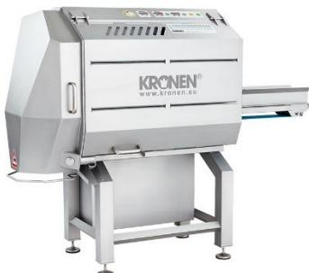
Die Multifunktionsmaschinen GS 10-2 und GS 20 schneiden unterschiedlichste Lebensmittel, natürlich auch Salat, Gemüse und Obst, effektiv, exakt und schonend und mit einer Kapazität von bis zu 1,5 t/h (GS 10-2) bzw. 4 t/h (GS 20).
