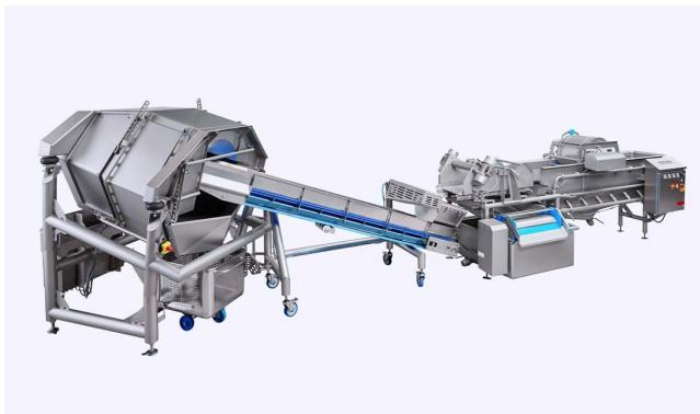
Das K1040H lässt sich optimal in Verarbeitungslinien integrieren und schleudert nasses Produkt, das aus einer Waschmaschine wie der HEWA 3800 kommt.
