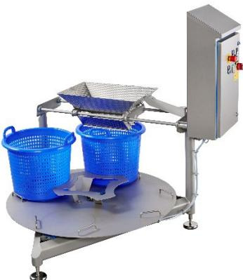
Das neue automatische Korbkarussell ermöglicht einen schnellen, hygienischen Korbwechsel und verhindert Produktverlust im Anschluss an den Waschprozess.
