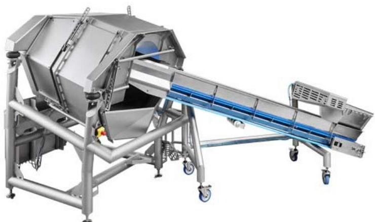
Das neue KRONEN Trocknungssystem K1040H für Salat, Gemüse und vegane Produkte wurde auf der Fruit Logistica 2026 erstmals vorgestellt. Die horizontale Zentrifuge ist platzsparend und trocknet die Produkte schonend und kontinuierlich.
