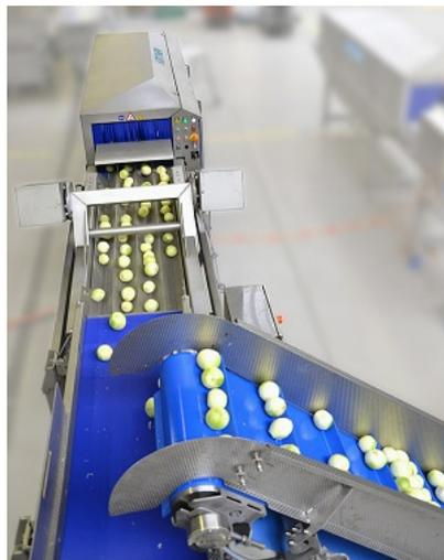
Die dritte Linie besteht aus einem horizontalen Förderband und einer UVC-Lock Entkeimungsschleuse, da ein Steigeband mit Bunker und ein Vibrationstisch für große Produkte wie Kohl nicht geeignet sind. Hier erfolgt die Vereinzelung der Produkte durch die manuelle Bestückung des Zufuhrbandes.
