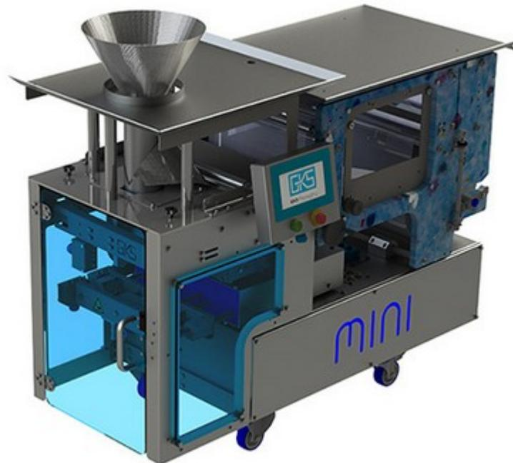
Mit einer Kapazität von bis zu 65 Beuteln pro Minute bei einer maximalen Beutelbreite von 160 mm eignet sich die MINI zur Herstellung portionsweiser Verpackungen für Schüttgüter wie z.B. Nüsse, geriebener oder gewürfelter Käse und Croutons sowie Flüssigkeiten wie Dressings und Saucen. Standardmäßig werden Kissenbeutel hergestellt, optional können aber auch selbststehende Beutel produziert werden.
